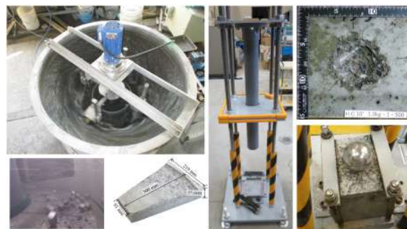
Fig. 6 頭首工エプロンの補修・補強材料の各種促進摩耗試験
