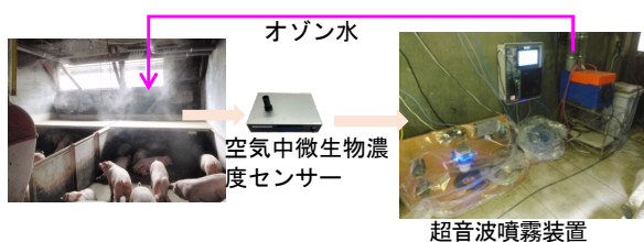
図6 オゾン水超音波噴霧システム
