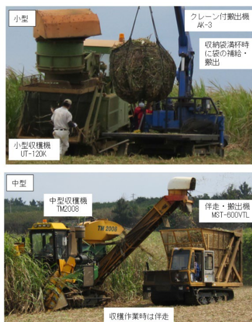
図3 収穫機と搬出機の連携による収穫作業
