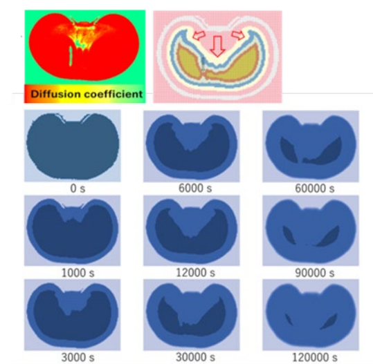
図 4 MA 貯蔵されたカキ果実を大気中に放置した際のガス拡散係数分布を考慮した \text{CO}_2 ガス移動予測 (薄青色: 濃度比初期の 0.8 以下)
