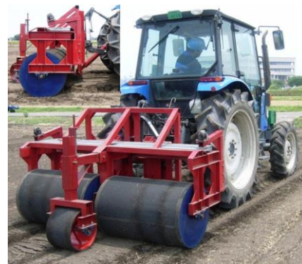
図6 開発した油圧鎮圧ローラ
