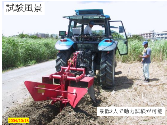
図2 溝堀作業の所要動力測定風景
