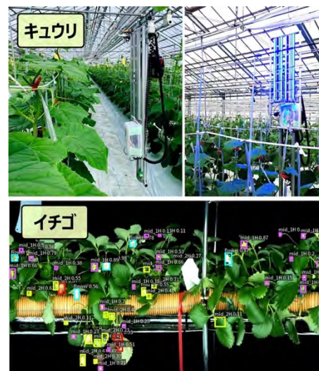
図 8 つり下げ型植物生体画像情報計測ロボットの適用事例(上段: キュウリ, 下段: イチゴ)
