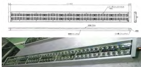
図3 試作したダイレクト水冷式ハイパワーLEDパネル 10)
