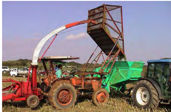
図4 細断型ロールベアラ試作2号機の定置作業
