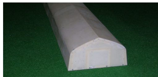
図2 パイプハウスの風洞実験用模型
