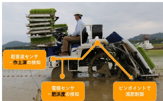
図4 リアルタイム可変施肥システムの概要 (出典:井関農機 HP)
