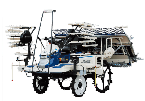
図2 土壌センサ搭載型可変施肥田植機 (スマート田植機)
