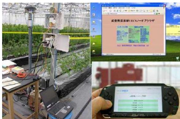
図 4 旧野菜茶業研究所低コストハウスの UECS 実証試験の様子(2005 年頃)。インターネット用各種機器・アプリで管理・記録が可能。
