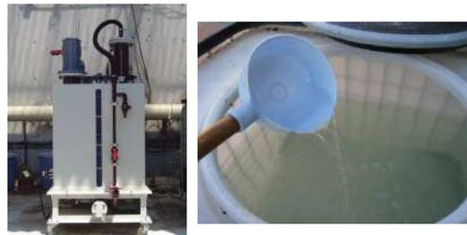
図3 開発したアンモニア回収装置（左）とリン酸を用いたアンモニア回収液（右）
