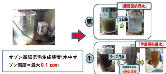
図5. オゾン微細気泡による豚糞尿と牛糞の脱色の比較
