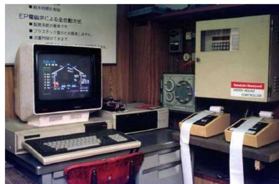
図1 神奈川県トマト生産者の施設で1984年に試験したPC-8801用のモニタソフトウェア(初出, 星 2018)。
