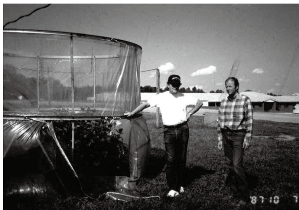
図2 オープントップ チャンバー (米国農務省研究局大気質研究プログラム)
