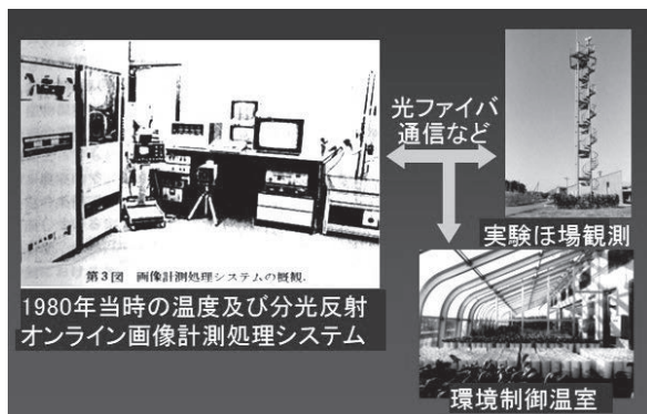
図2 1980年頃の植物機能診断のためのオンライン画像計測システム
