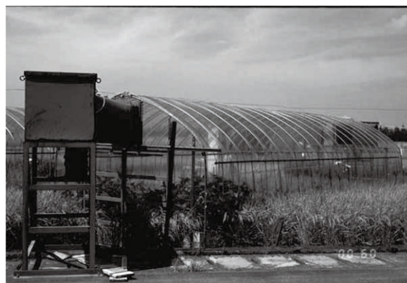
図1 水田に設置したオゾン暴露チャンパー
