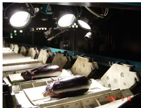
図 7 ロータリーパケットを利用した選果システム
