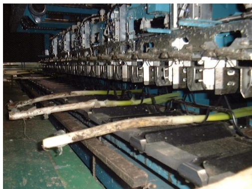
図9 マシンビジョンに基づく長ネギ皮剥ぎシステム
